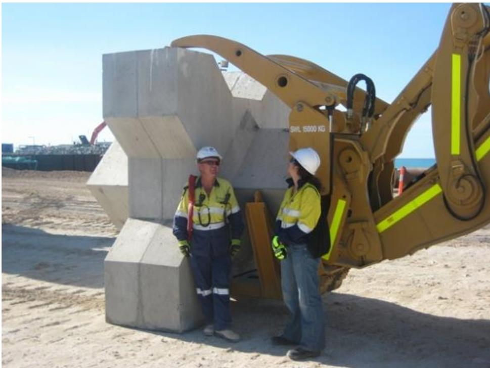
Figure 1 - Xbloc armour unit (DMC, 2011)<sup>7</sup>
